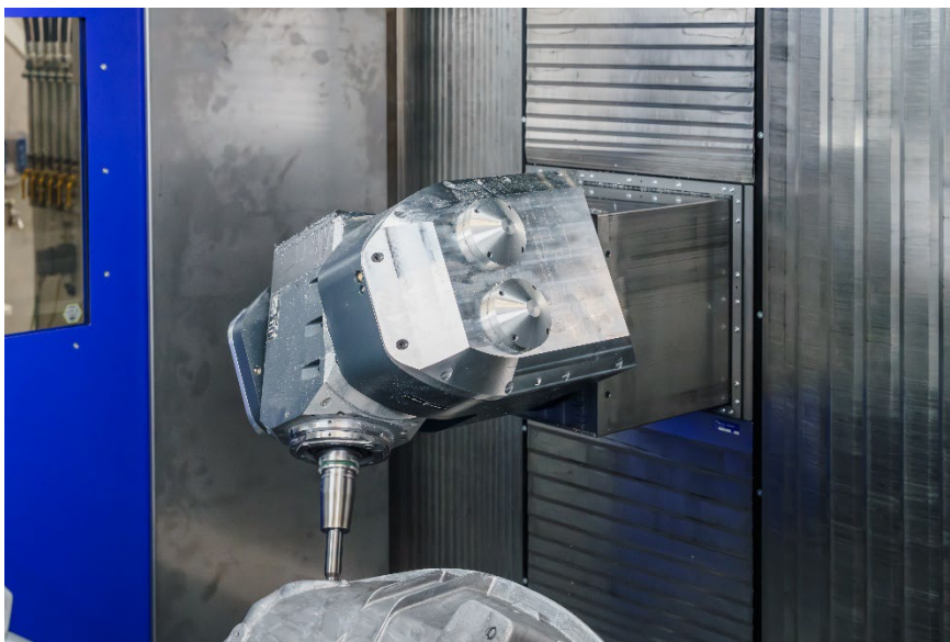
Bild 3 + 4: Präzise Zerspanung eines Megacasting-Bauteils
