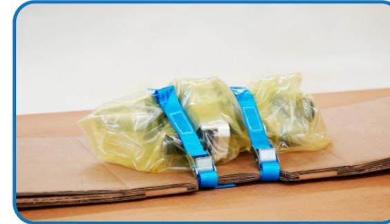
**Aggregat verpacken:** Für den Rückversand muss das Aggregat in die gelbe Folie eingewickelt werden. Anschließend muss das verpackte Aggregat mit den beiden Spanngurten auf dem Karton gesichert werden, um ein Verrutschen während des Transports zu verhindern.
