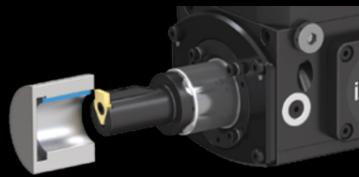
**Innenbearbeitung** eines Werkstücks mit einer Stoßeinheit
