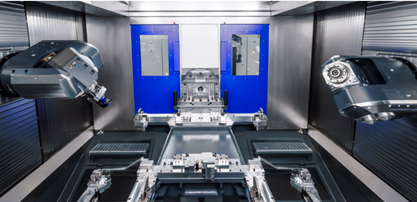
BENZ Tooling 5-Achs-Köpfe in einem WH 10000 5-Achs-Bearbeitungszentrum der August Wenzler Maschinenbau GmbH, einem Unternehmen der HELLER-Gruppe. Die vierte und fünfte Achse befindet sich im 5-Achs-Kopf, wodurch beide Einheiten mit hoher Bewegungsfreiheit arbeiten können. Das Zusammenspiel aus Maschinenkinematik und Werkzeugtechnologie ermöglicht eine präzise, simultane Bearbeitung auch komplex geformter, großformatiger Strukturbauteile (Megacastings), die mit herkömmlichen Maschinenkonzepten nur schwer zugänglich wären.
